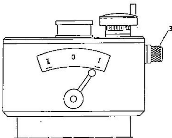
Для создания условий, позволяющих всегда работать с максимальным числом оборотом двигателя, станок EFCO TD укомплектован двухступенчатой промежуточной передачей. Следовательно представляется возможным обеспечить число оборотов шпинделя в следующем диапазоне:
