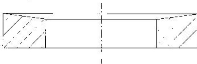
Рис. 16. Поверхность уплотнения волнутая
